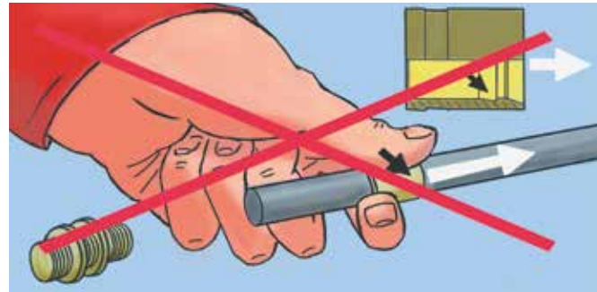
Гильза надета «не той стороной»: фаска внутри гильзы направлена в противоположную сторону от фитинга
